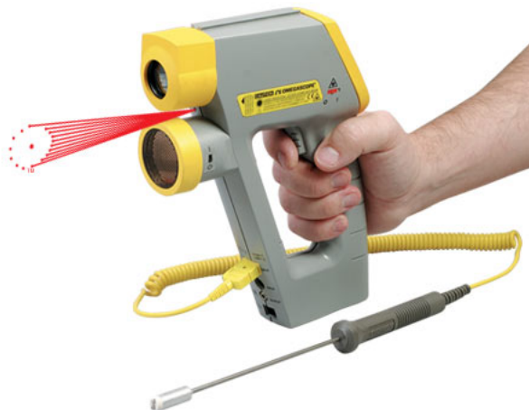
Slika 1.7: Primer IR termometra z laserskim namerilcem, ki nam označi mesto meritve.
